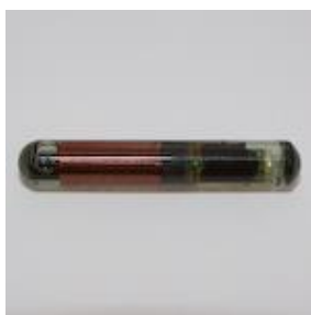
23 mm PIT mærke, der indopereres i fisken som efterfølgende kan registreres på en antenne i vandløbet.
