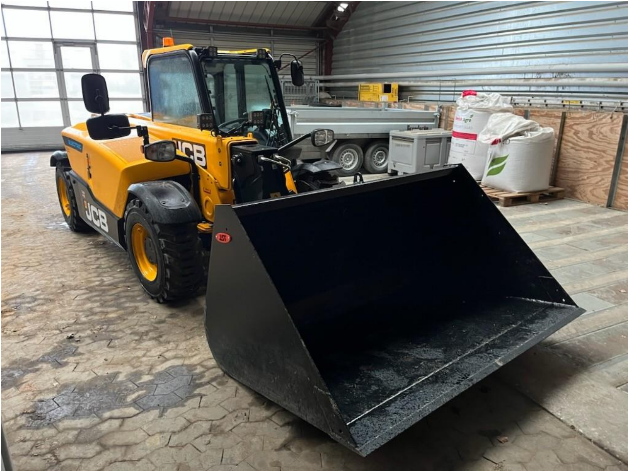
JCB 525.60 teleskoplæsser til transport af materiel. Herunder til transport af NGT plantemateriale i dobbeltposer i aflukkede containere (som beskrevet i ansøgningen) mellem det anvendte markareal I Flakkebjerg og GM klassificerede laboratorier og faciliteter i Flakkebjerg.
